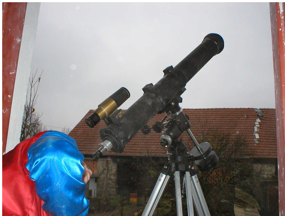
Refraktor 100/100 na paralaktickej montáži od UNIWESAL.EU. Len tak vo dverách hviezdárne za jasného dňa
